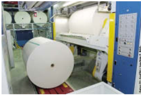
Nach dem Auspacken der Rollen folgen automatisch sowohl Klebevorbereitung als auch Transport zum Tageslager.
