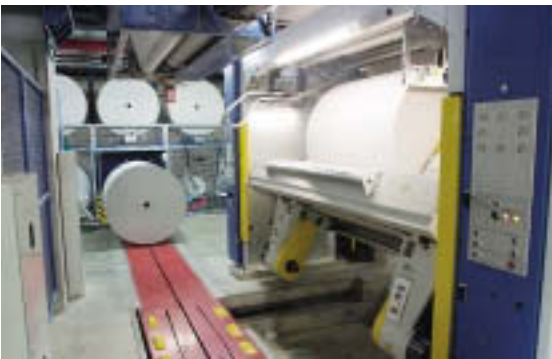
Vom Lkw automatisch in das Hochregallager und von dort rechnergesteuert kommen die Rollen in die Produktion.
